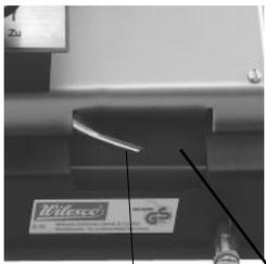
Pour vider le réservoir d'eau d'alimentation, dévissez le bouchon de vidange et recueillez l'eau dans un récipient. Ensuite, revissez le bouchon de vidange avec le joint (voir illustration à gauche)
